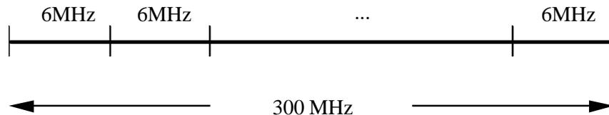
**Figura:** Multiplazione di più trasmissioni su un unico canale
